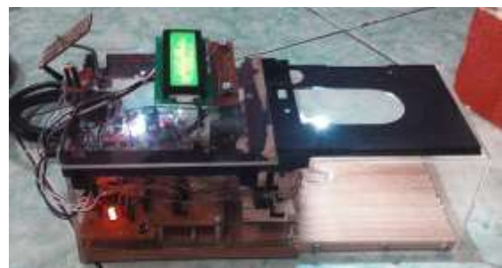
Gambar 10. Foto alat atap otomatis tanaman hidroponik
