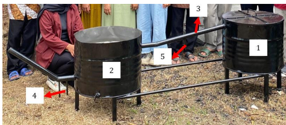
Sumber: (Dokumentasi Penulis, 2025) Gambar 2. Teknologi Proses Pirolisis Arang Dan Asap Cair
