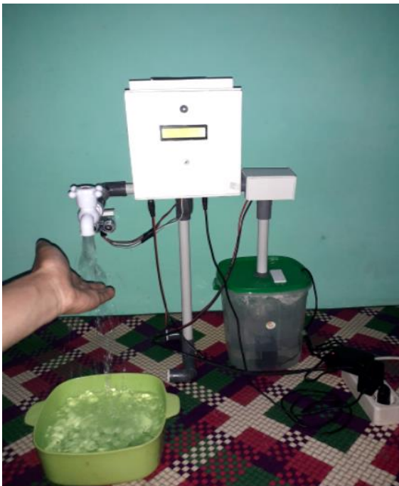
Gambar 13. Pengujian Sensor Ultrasonik HC-SR04
