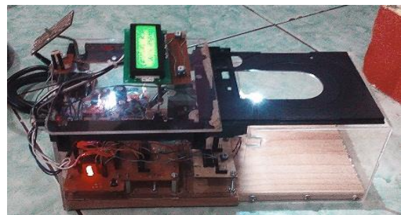
Gambar 10. Foto alat atap otomatis tanaman hidroponik
