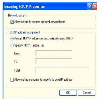
Sumber: Hasil Olahan (2013) Gambar 3. Konfigurasi network pada server VPN
