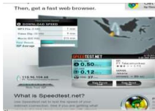
Gambar 4.10. Hasil Pengukuran *Bandwidth* Setelah *Queue Tree*
